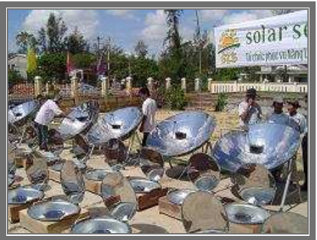
Đội ngũ nhân viên - 10 chiếc bếp hình parabol và 50 chiếc bếp hình vuông Tờ giấy bốc cháy trong 30 giây
