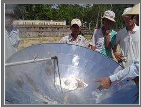
Đội ngũ nhân viên - 10 chiếc bếp hình parabol và 50 chiếc bếp hình vuông Tờ giấy bốc cháy trong 30 giây
